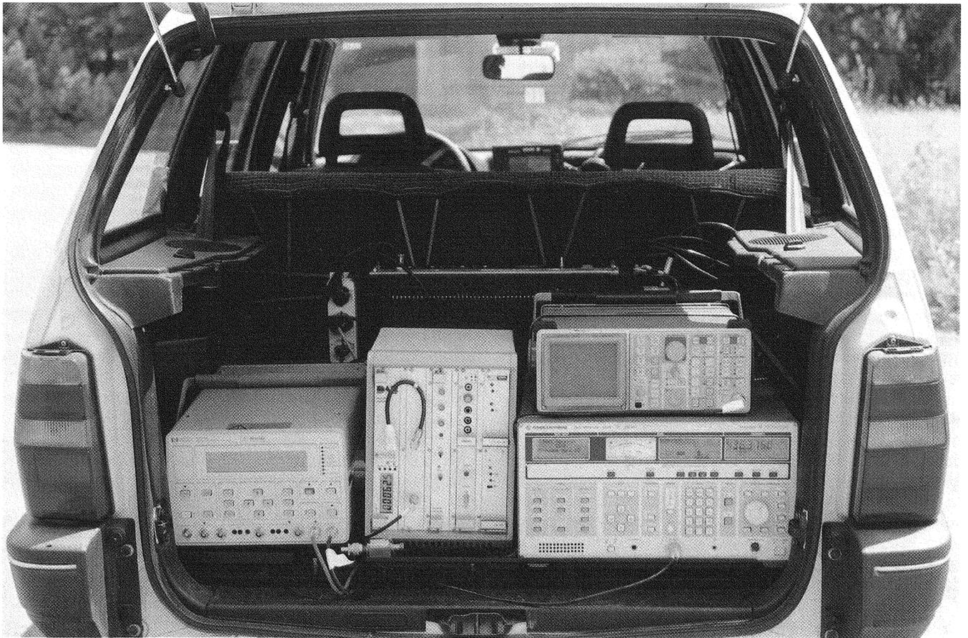
Fig. 2 — Fotografia dell'auto attrezzata per le misure.
